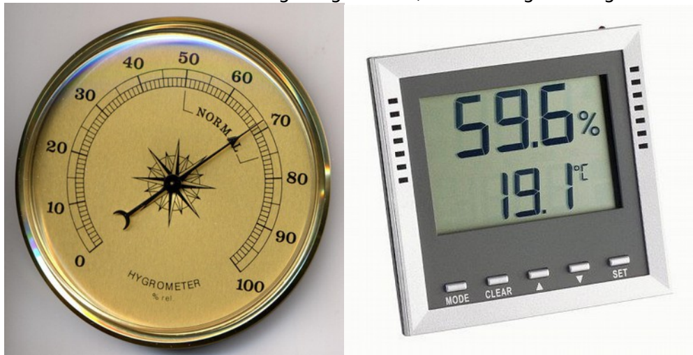
Slika 9: Levo – klasični analogni higrometer; desno – digitalni higrometer
